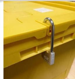
Sicherung der Transportbox mittels Vorhängeschloss bei Transport durch eigene Mitarbeiter/ Dienstleister bis 120 CASA im Fahrzeug
